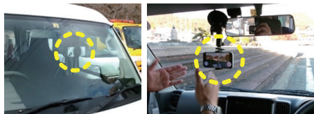
GLOCAL-EYEZ を用いた路面性状調査
