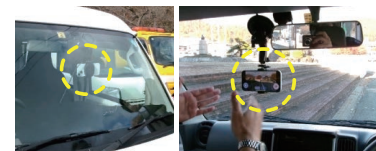
△ GLOCAL-EYEZを用いた路面性状調査
