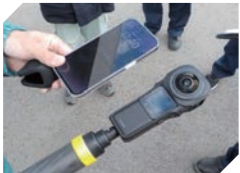
360°カメラで全体の状態を把握し、損傷箇所をスクリーニング
