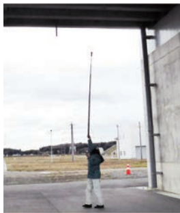
360°カメラで全体の状態を把握し、損傷箇所をスクリーニング
