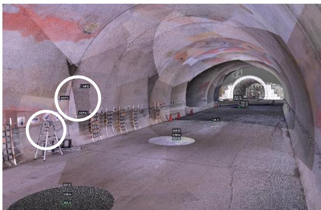
◁点群データによるトンネル内部の3Dモデル (測定項目のマーク位置と模擬変位部が確認できます)
