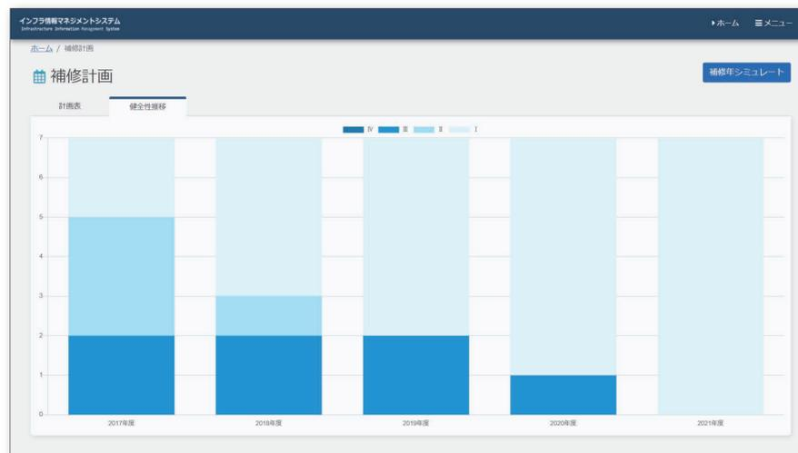
補修方針(点検時簡易補修、概算発注工事、詳細設計付工事)に基づく補修計画案の策定を支援。複数年にわたる計画を見据えて事業費を分割して設定でき、補修計画による健全性の推移も確認できます。
