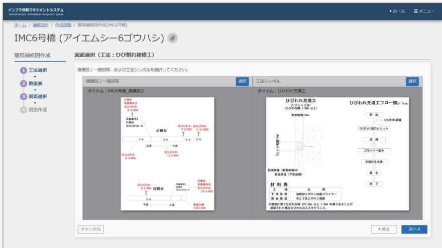
補修方針：概数発注工事については、点検調書の損傷図や損傷写真を活用し、簡易補修図を作成することができます。
