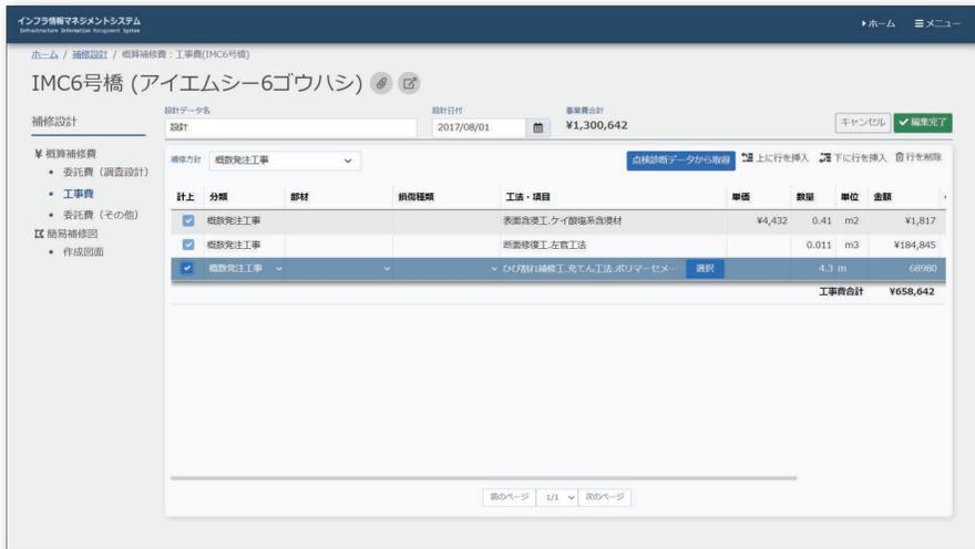
橋梁の補修にかかる概算補修費を設定します。概算補修費は、委託費(調査設計)、工事費、委託費(その他)の3構成となっており、それぞれでの集計が可能です。
