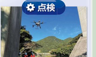
橋梁の3Dモデル構築と点群計測処理による変状寸法の算出技術
