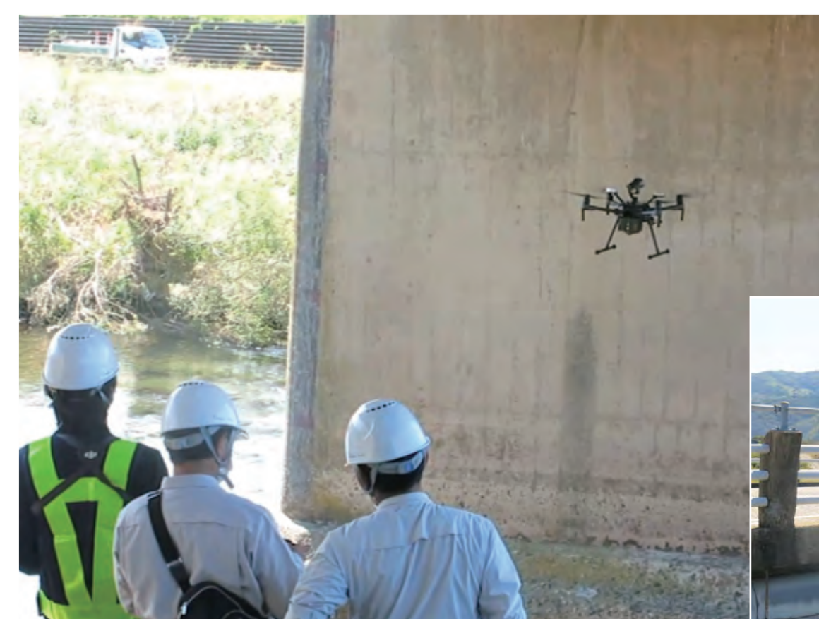
健全度Ⅲの橋梁で、補修対象が桁端部、桁下全体にあるため、ドローン点検と橋梁点検車を併用。
