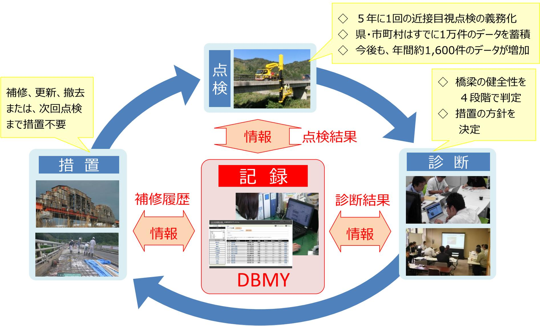
**DBMY** は、橋梁のメンテナンスサイクル（点検、診断、措置）の情報をデータベース化
